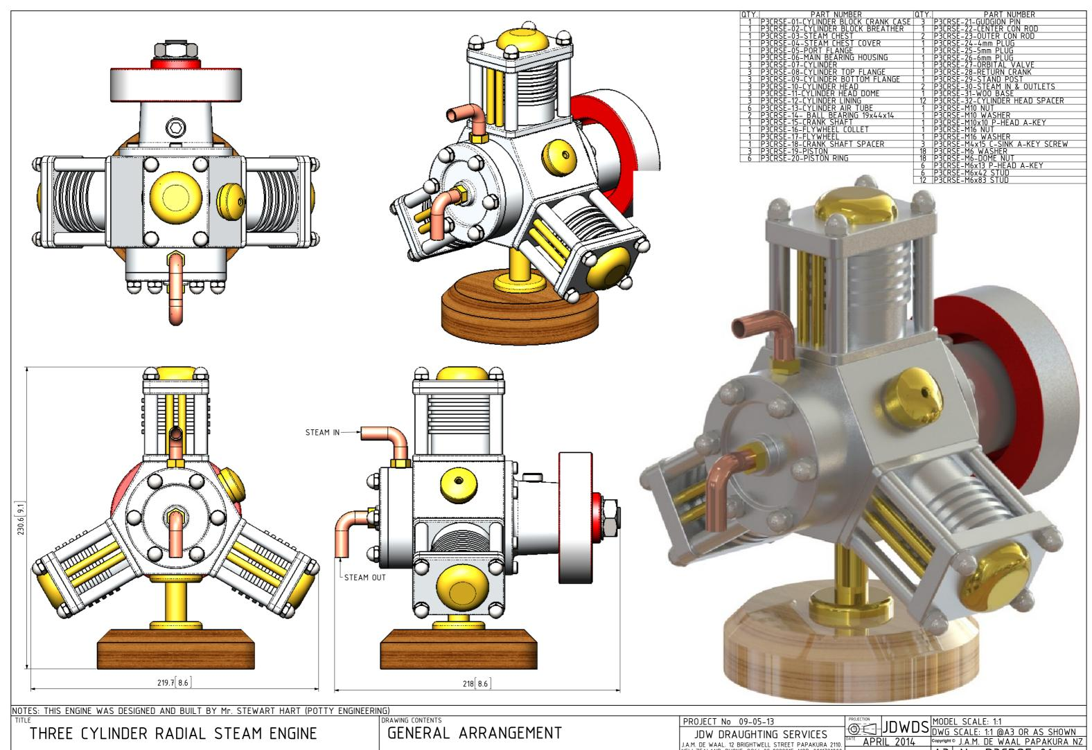
THREE CYLINDER RADIAL STEAM ENGINE
