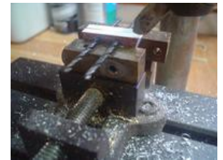
Retournement et usinage des trous et usiner.
