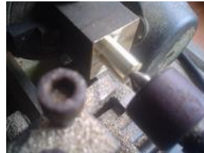
usinage avec contre-pointe tournante
