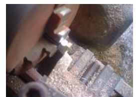
..et usiner : la tige filetée qui sert de support peut aussi servir de guide d'épaisseur
