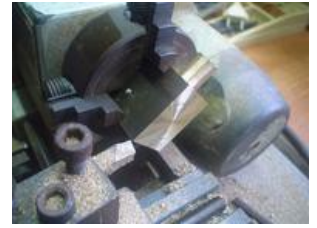
dressage des faces pour atteindre la bonne cote en partant du tétou
