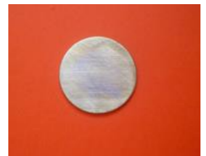
chauffer, enlever le tube, essuyer à chaud l'étain, poncer
