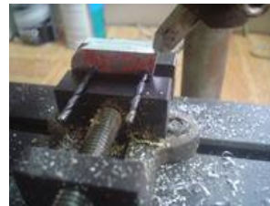
Enfiler deux forets de 2 dans deuxième côté.
