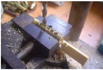
perçage de trous jointifs
