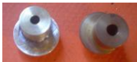
à gauche excentrique obtenu avec cette méthode droite, excentrique réalisé avec un mandrin à 4 mors
