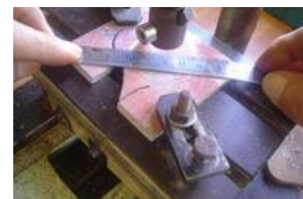
contrôle sur une plaque d'aluminium bien bloquée
