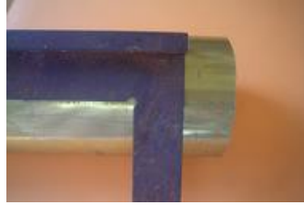
en partant de la première ligne, repérage facile de la seconde ...
