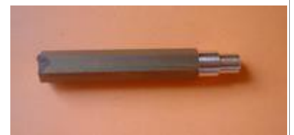
tournage aux dimensions de la chape
