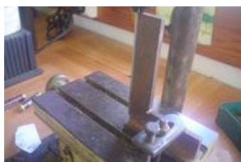
positionnement d'une équerre à chapeau
