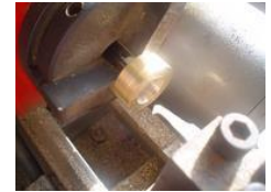
reprenre avec l'outil à aléser pour arriver au diamètre 11 bien centré
