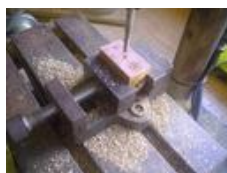
perçages à 1.2 et filetage à M3
