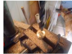
terminer le trou à la perceuse : ici un foret de diamètre 10.5
