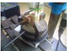
une fois les trous de fixation du couvercle percés à 1.6, faire un repérage sur le corps ; percer à 1.6, faire un repérage sur le corps ; percer à 1.6, tarauder à M2 puis repercer le couvercle à 2.2
