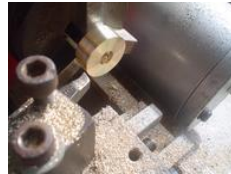
retourner puis percer à 7 ou 8 pour ne pas forcer le tour
