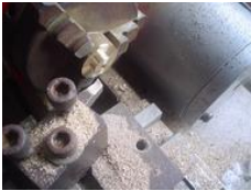
réaliser le téton de diamètre 8 du couvercle
