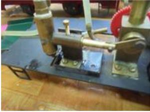
qui perdra toujours un peu d'eau que l'on peut renvoyer dans le réservoir avec ce petit système réalisé en tôle.
