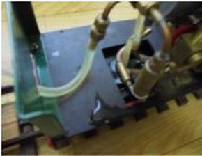
On en revient alors à la première solution qui consiste à ouvrir un peu le réservoir annexe qui s'alimente dans le bac qui se remplit lentement. Pour cela on bouche (rond de laiton sans le souder) le tube .
