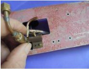
Lors du montage, bien calculer l'épaisseur du joint pour qu'après serrage on obtienne ce montage (personnellement j'ai ajouté un peu de téflon de plomberie).
