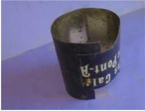
Nouvelle enveloppe en tôle qui va se positionner à l'intérieur et cacher l'ouverture nécessaire.
