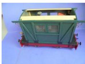
Le wagon doit s'emboîter facilement. Si cela coince on peut agir en déplaçant le réservoir annexe vers l'intérieur et vers l'avant (modifier le trou de fixation) ; ou encore déplacer le porte-piles vers l'avant (nouveau trous) ; ou encore scier un bout de l'interrupteur.
