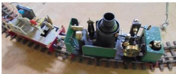
On obtiendrait de meilleurs résultats avec un moteur différent de l'oscillant dont les pertes sont très importantes, un moteur à tiroir cylindrique par exemple.
