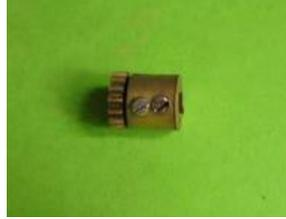
Ajout d'une seconde vis de blocage sur la roue dentée de l'axe moteur.
