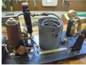
Elle se glisse autour du serpentin avant de réaliser la jonction du serpentin avec la tubulure du graisseur.
