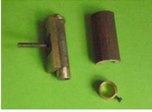
Le cylindre n'est pas bien beau, on va l'habiller avec du bois et pour le maintenir, on ajoute une bague en bas du cylindre. Il ne faudra pas oublier de percer la garniture en face du trou d'échappement en fin de course si on l'a percé. Et, cette fois il est plus présentable.
