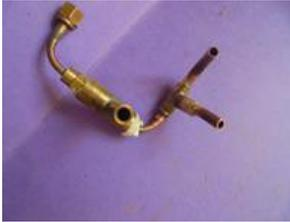
On va modifier la partie "aspiration" : un té (brasé à l'argent) reçoit un coude menant vers le raccord de pompe ; au centre un tube va mener vers une aspiration en fond de bac (prévoir un clapet pour que l'eau ne retourne pas au bac) : à l'autre extrémité, un coude menant via un tube en silicone vers le réservoir.
