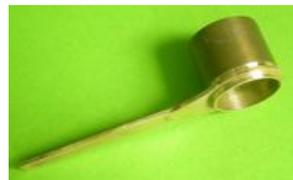
Il est possible que la bague se soit un peu déformée pendant la brasure.
