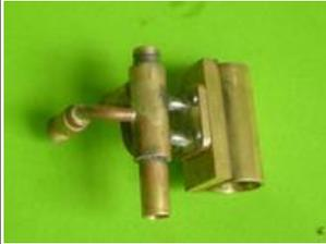
Fixation avec 4 vis en acier M1.6. Pas facile d'un côté mais un tournevis d'opticien fait l'affaire.
