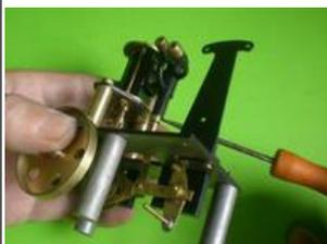
Réglage de la position du tiroir : lorsque le piston est au PMH, notre tiroir doit être en position médiane.
