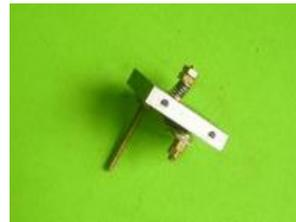
Sur le **support arrière**, pour le pivotement du balancier, un ressort permettra de le régler en position stable grâce au levier. Les têtes des vis qui servent de pivots ont été reprises au tour pour ne laisser qu'un rond de 0.5 d'épaisseur. Ces pivots seront soudés à l'étain. *Il faut les plier pour éviter que les éléments superposés ne se touchent.*
