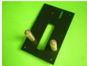
**La platine.** Elle sera modifiée pour permettre le montage du levier : la fente arrière débouche désormais sur le côté arrière comme sur le plan.
