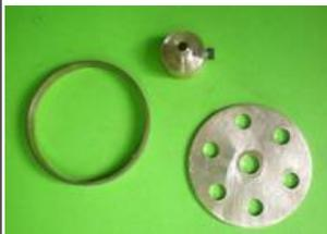
**Le volant** tout simple : une bague de 38 x40 et de 5 de large, un disque de 1.5 d'épaisseur et 38 de diamètre, un moyeu tiré d'un rond de 16.
