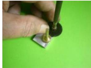
On approche la roue à positionner de la Première fixée sur son axe, on vérifie que ça Tourne correctement et on pointe.
