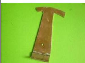
Ébauche du **guide du levier** : en laiton ou cuivre de 1 d'épaisseur pour éviter un pliage en soudant à l'étain une équerre de 6 x 6.
