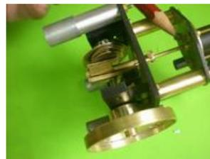
Réglage de la tige de piston en l'enfilant puis en bloquant.
