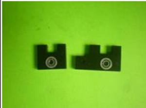
L'arbre moteur sera soutenu par **deux supports** équipés de roulements à épaulement. Il faut une découpe pour pouvoir glisser les écrous des tiges de fixation.
