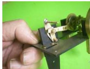
Équiper le troisième support du balancier, le positionner (vis non serrées), enfiler la bielle de l'excentrique, visser après avoir positionné de manière à ce que le balancier soit vertical.
