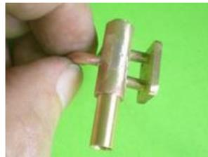
On enfle le tube de 5 x 6, on le positionne, on place les tubes de jonction et la patte de fixation : décapant sur les tubes et aux extrémités du tube 6 x 8; un peu d'étain et c'est tout bon.
