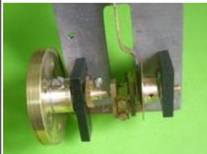
Vissage, montage du volant et réglage latéral, le maneton bien au centre.
