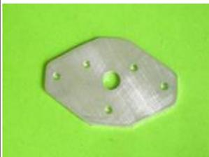
Découpe du support du moteur dans de l'aluminium de 2 d'épaisseur.
