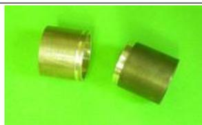
Préparer un rond de 15 ou 16 (à droite) et amener sur 2 mm au diamètre 14.
