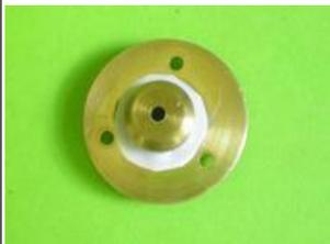
**Joint pour le chapeau inférieur** : on peut remplacer l'enroulement de téflon tressé par un joint en téflon de 0.25. La on réalise un trou de 8 mm à l'emporte pièce et ça s'enfile bien sur notre rond de 10 qui possède une gorge.
