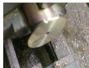
Réalisation du disque de 20 de diamètre et de 0.5 d'épaisseur.
