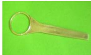
Découpe de la bielle dans de la tôle de laiton de 1 mm d'épaisseur et ajustage de la liaison avec la bague.
