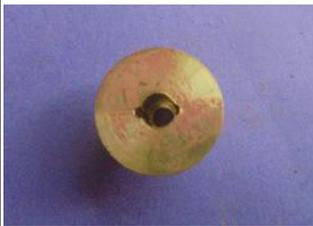
Le **porte-bille** : le trou de 4.2 ne sera exécuté qu'après le perçage des trous de 1.3 qui permettent le passage de la vapeur.
