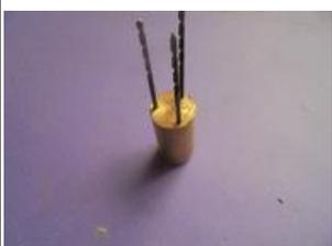
Les trous sont parfaitement alignés on peut agrandir ceux des couvercles à diamètre 2 et tarauder ceux du cylindre à M2.
