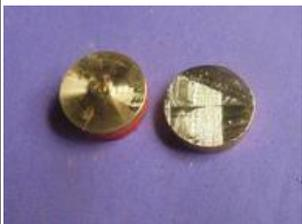
L'**arrivée vapeur** avec un petit décrochement de 4 mm de diamètre et rainuré à la fraise de 1.5 peut-être inutile ? Mais cela assurait un bon maintien pour le tournage ...
