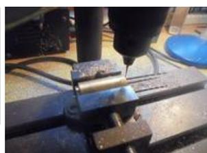
Avec une petite fraise, repérage de la position du couvercle et du cylindre.
