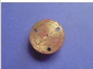
Avant de percer le trou de 2 que l'on agrandira ensuite à 3, procéder au traçage des trous à 120° et les percer à 1.6
