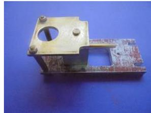
support du cylindre et support axe moteur
