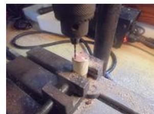
Percer en se servant du premier couvercle jusqu'au cylindre à diamètre 1.6.
