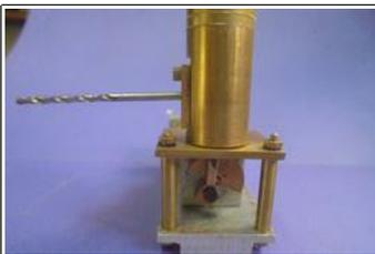
Sur cette photo, on voit que le piston en position de PMB (fin de l'échappement) n'est pas tout à fait vertical.
