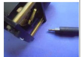
Il y a mieux en utilisant de l'hexagone qui serre bien dans la clé à douille.
