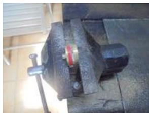
En passant, un petit truc pour le sciage d'un bout de rond de 16 qu'on ne veut pas perdre : guider le sciage avec une petite bande adhésive.
