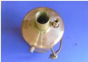
Le chapeau de la chaudière que l'on percera pour le passage de la cheminée et celui de la soupape.
