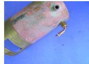
Montage du raccord sur le tube de sortie de la chaudière : soudure à l'étain
