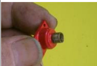
Tête de refoulement vue de l'extérieur.
