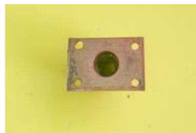
En examinant bien la photo on aperçoit les rainures obtenues par fraisage.
