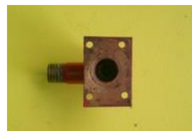
Un simple trou de diamètre 6 sur 5 de profondeur qui a agrandi celui de 3 percé au préalable.
