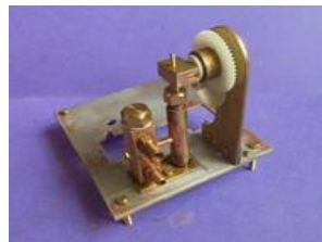
On est prêt pour l'essai final qui avait déjà été précédé d'un autre essai sans démultiplication pour vérifier que ce montage fonctionnait avec de l'huile SA 1000 !
