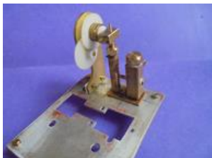
Vérification de la course du piston et du fonctionnement du coulisseau..
