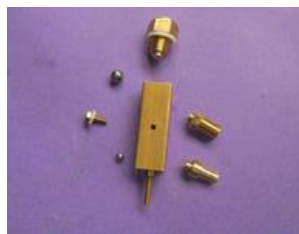
corps de pompe et équipement*
