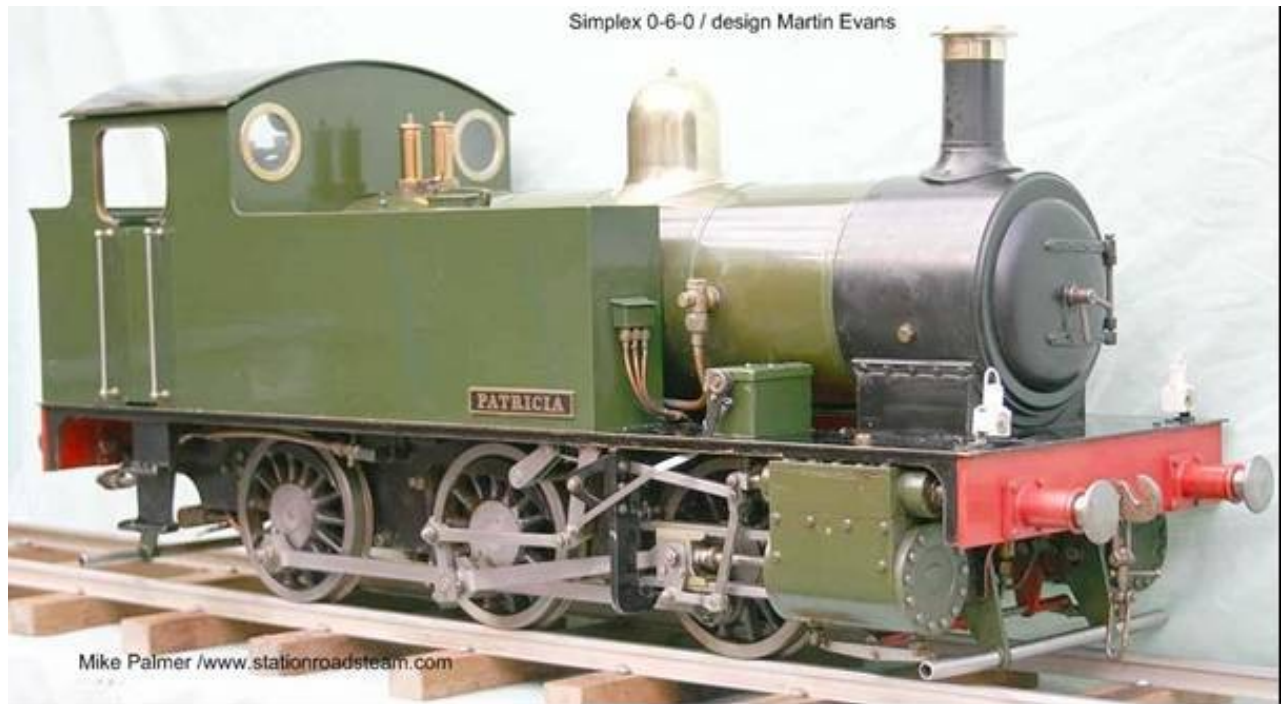
Simplex 0-6-0 (design Martin Evans), une machine puissante et fiable Machine qualifiée « pour débutant » ; échelle 1/12 pour voie de 5 " (127mm)
