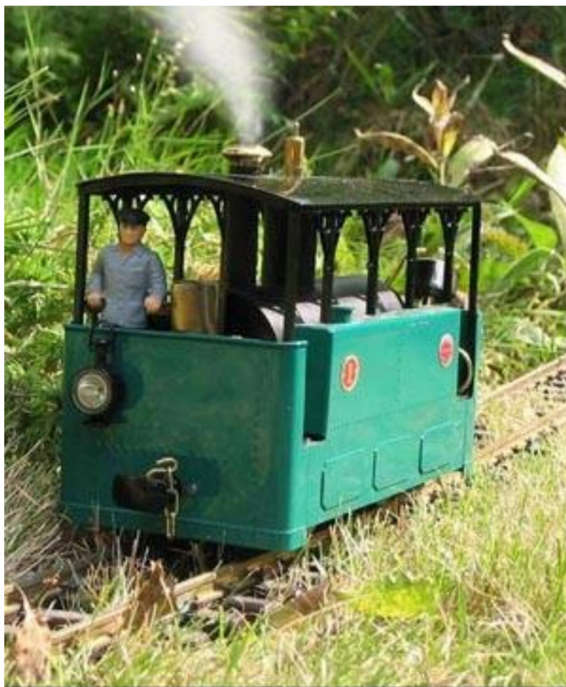
Locomotive Sarthe 4 Voie de 45 mm, Echelle 1/22eme. Longueur 252, Largeur 92 mm 150 mm de hauteur. Masse environ 2 kg Plans disponibles sur http://vapeur45.free.fr/
