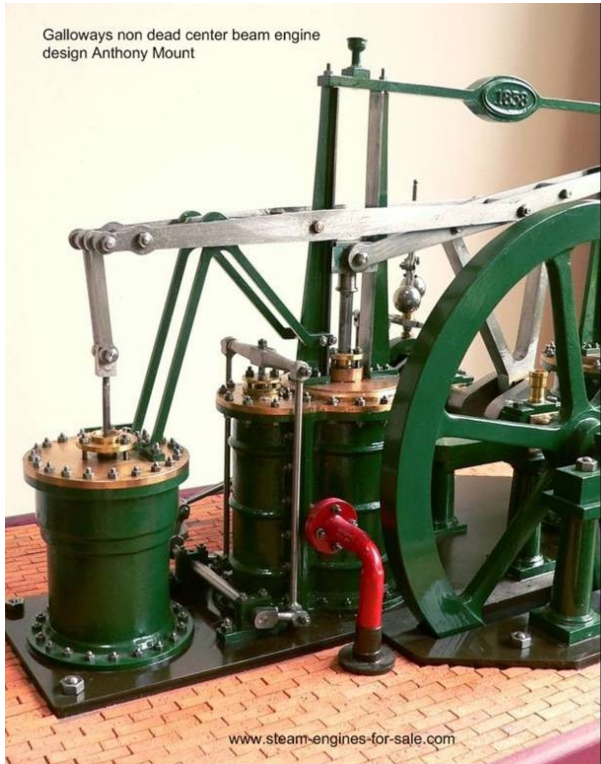
Galloway Non dead center Beam engine (Design Anthony Mount). Moteur à balancier sans point mort. Un superbe projet et une machine fascinante à voir fonctionner.
