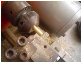
préparer le rond et le percer à 1.7
