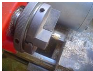
filetage et estimation de l'espace restant à fileter
