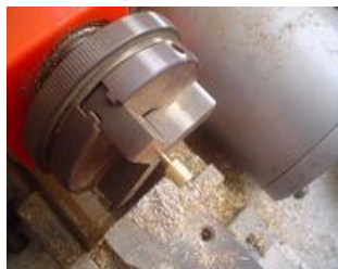
préparer la tige (1.6) et vérifier le débattement
