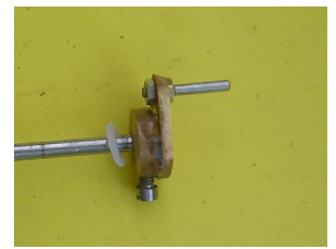
avant soudure du maneton
