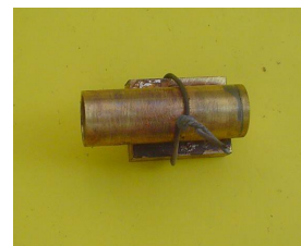
après la soudure à l'étain
