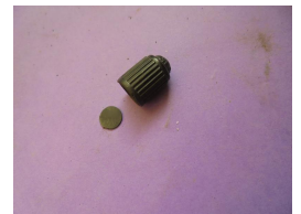
bouchon rendu étanche rondelle de nitrile de 1 d'ép.
