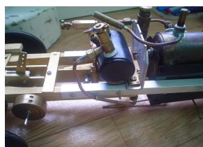
La mise en place du raccord entre le gicleur et le réservoir pose quelques problème.
