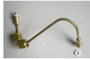
tubulure avec joints en téflon
