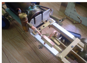
Avec la brasure à l'argent les tubes reprennent de l'élasticité et on peut peaufiner leur mise en place.
