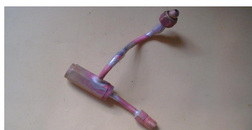
La liaison de la vanne au moteur doit se faire avec un tube de cuivre de 2 x 3 et non pas de 3 x 4 où la vapeur va se détendre un peu comme sur la photo.
