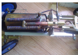
Couper le tube du brûleur qui doit être centré au milieu de la chaudière et dont le gicleur ne doit pas toucher le bâti du moteur.
