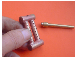
perçage puis brasure de l'arrivée de gaz
