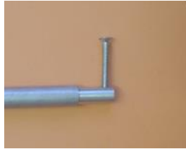
perçage puis taraudage à M3
