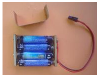
Piles en place et au-dessus, un "capot" en tôle.
