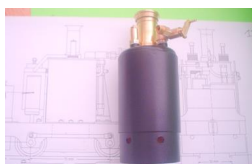
la chaudière réalisée
