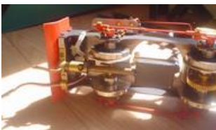
Visser le support sur le châssis en faisant passer le câble du servo.
