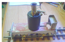
la chaudière en place
