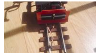
Entrée pour le gaz et sortie du câble.
