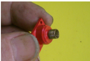
Tête de refoulement vue de l'extérieur.
