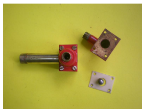
En examinant bien la photo on aperçoit les rainures obtenues par fraisage.
