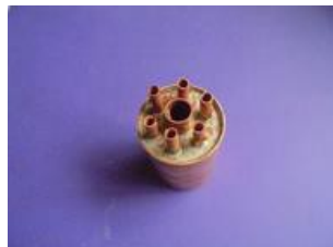
partie supérieure brasée, reste à scier à ras les tubes de 4 x 5
