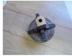
Placer le montage obtenu dans le mandrin 4 mors : réglages du serrage sur l'établi.
