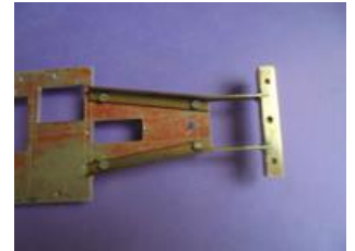
soudure à l'étain
