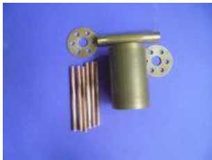
toutes les pièces, on aperçoit la reprise à 11.6 du tube central.
