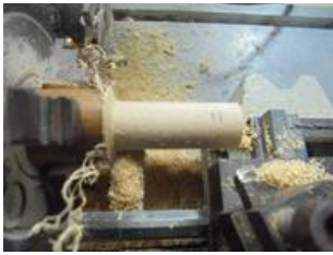
rond de diamètre 13, repérage position 1 de l'outil
