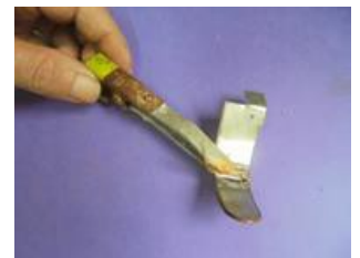
soudure des pattes (laiton 0.5 x 4)
