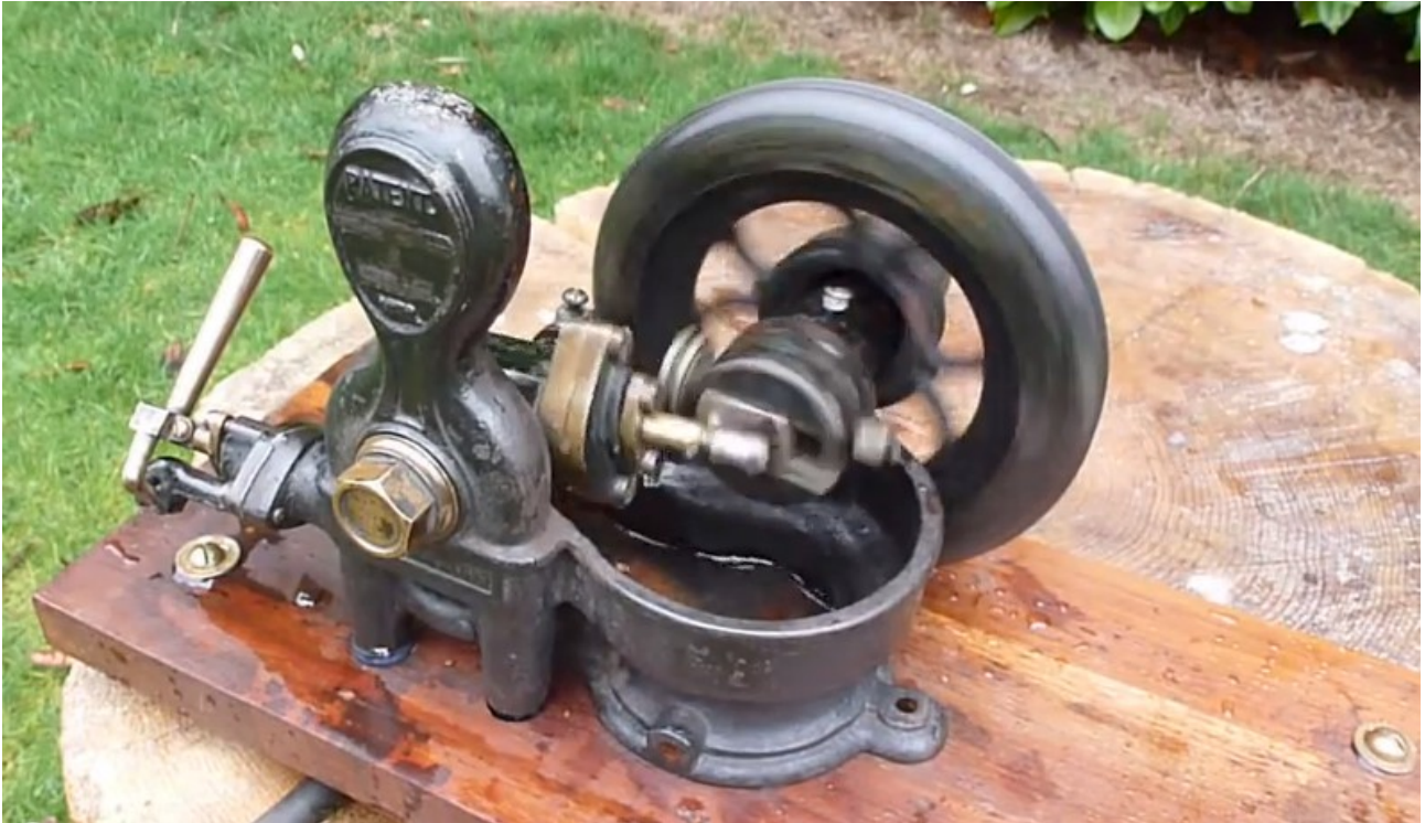
Moteur américain à eau pressurisée (brevet de 1878) Visible ici https://www.youtube.com/watch?v=lyPTUKqkX9g
